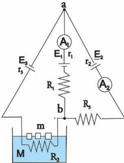
446. En la red dada y siendo  $E_1 = 25V$ ,  $E_2 = 10V$ , y  $E_3 = 10V$  y las resistencias internas respectivas de los generadores  $r_1 = 1\Omega$ ,  $r_2 = 1\Omega$ ,  $r_3 = 1\Omega$ . Siendo  $R_1 = 19\Omega$ ,  $R_2 = 19\Omega$ , y  $R_3 = 9\Omega$ , y estando dispuesta  $R_2$ , tal como indica la figura, como un calentador de una mezcla de una masa  $M$  de agua (1kg) en la que flota una masa  $m$  de cubitos de hielo (80g), podrás asegurar que :
